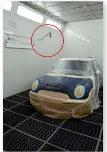
▲ Blick in unsere Lackierkabine, eine der modernsten in Deutschland. Ein Laser (roter Kreis) misst die Objekttemperatur und sorgt so für eine gleichmäßige Trocknung.
